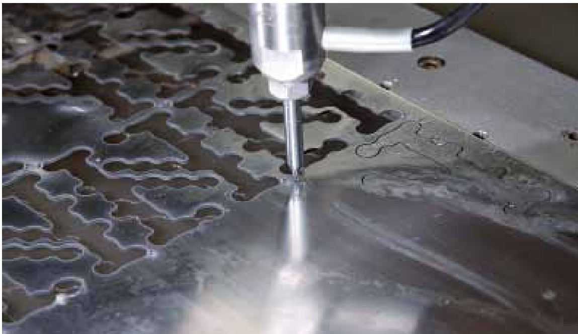
Die Microwaterjet-Bearbeitung ist fünf Mal kleiner und zehn Mal genauer.
