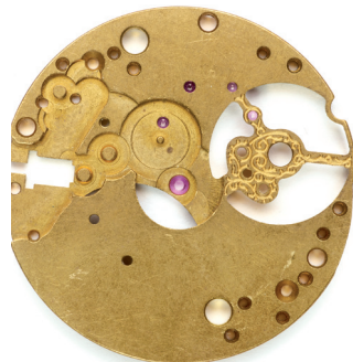
Mit der Mikro-Wasserstrahlschneidtechnologie wurden Präzisionschnitte dicht an die bereits eingepressten Lagerrubine der Uhrnplatte ausgeführt.
